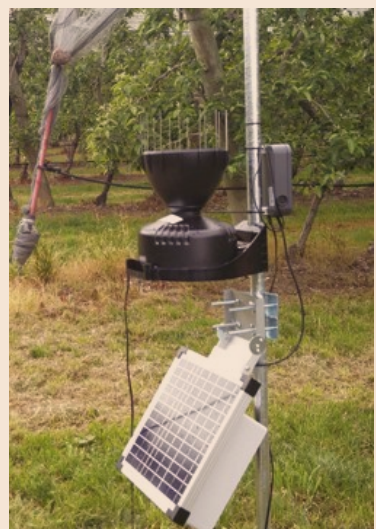
Tra i filari. La soluzione con sensori, pannello solare e modulo di trasmissione nei vigneti di Ca' del Bosco
